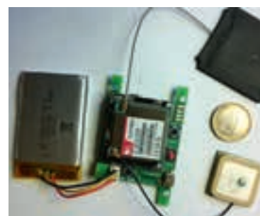
▲ Traceur GPS communiquant multicanaux pour le suivi de position d'animaux.
